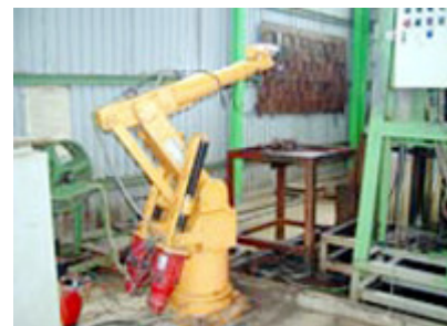
Robot vận năng cấp phôi cho máy tôi cao tốc.
