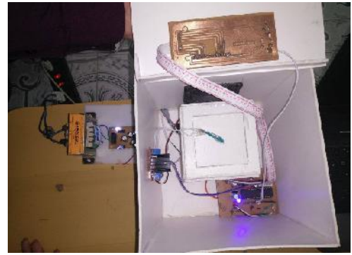
Hình 2: Hệ điều khiển nhiệt độ sử dụng Arduino
